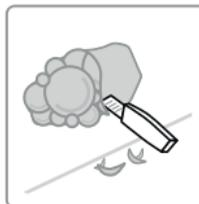
Au bout de 2 à 3 h, éliminer l'excédent de mousse à l'aide d'un cutter.
