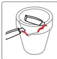
Dans les 10 à 15 min. après application, éliminer au cutter les débords de mastic, avant durcissement du mastic.
