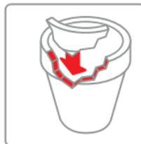
Repositionner le morceau cassé à son emplacement d'origine. Assembler en exerçant une pression, pour expulser le surplus de mastic, jusqu'à prise du mastic (rapide, <5min.)
