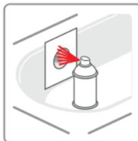
Faire 1 gabarit (carton, papier) à la taille de la réparation, le maintenir 2 cm au-dessus, vaporiser le spray 15-20 cm au-dessus en fine couche. Attendre 1 min. avant d'appliquer la 2ème couche.
