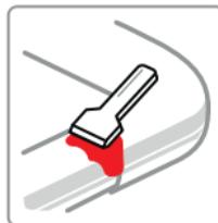
Appliquer la Soudure à Froid, à l'aide de la spatule fournie, sur les zones préparées.
